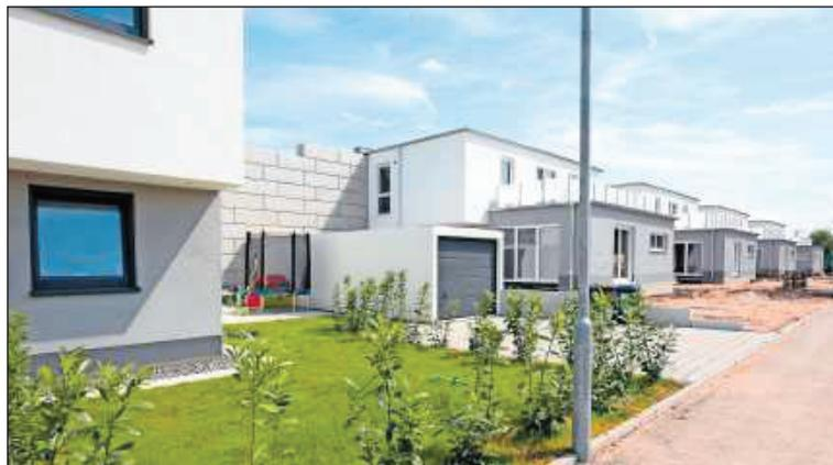
Wohnen an der Bahnlinie: Die Doppelhäuser sind in die Schallschutzwand integriert.
